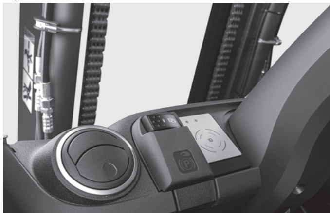
Perfetta stabilità in ogni posizione grazie al freno di stazionamento elettroidraulico
