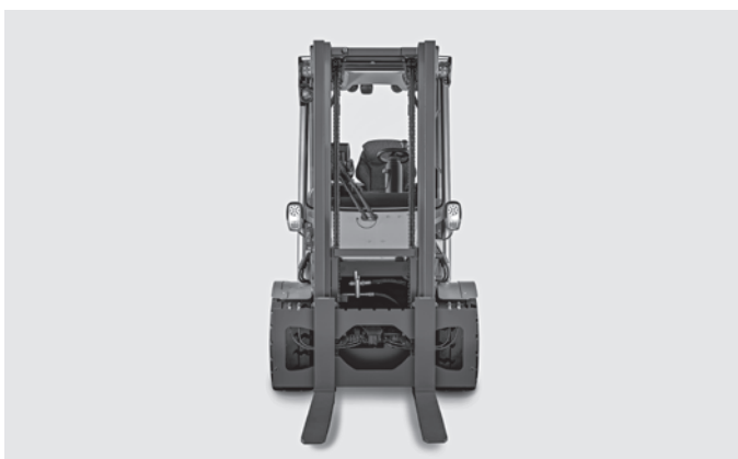
Il montante dal profilo slim garantisce una visuale ottimale sulle forche e standard di sicurezza molto elevati
