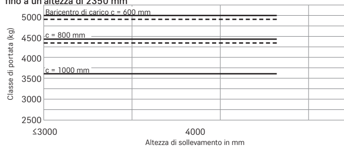
RX 60-50/600 montante triplex/gommatura SE semplice fino a un'altezza di 2350 mm
