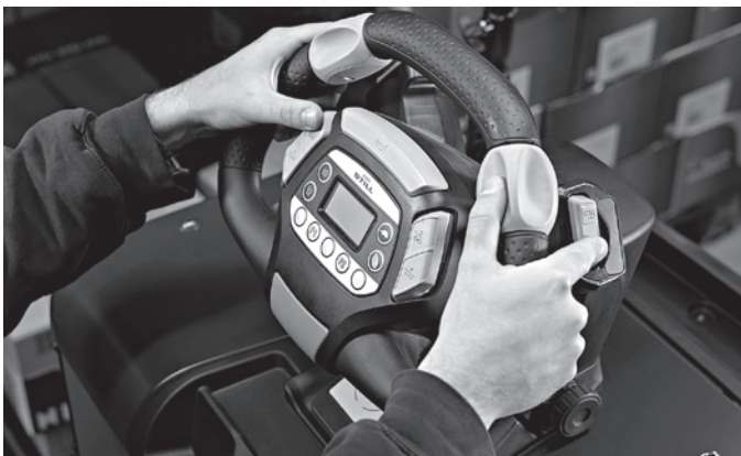
L'esclusivo volante STILL Easy Drive assicura una risposta di guida ottimale e permette agli operatori di utilizzare tutte le funzioni senza dover cambiare mano
