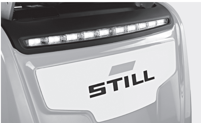
La luce di marcia diurna intelligente a LED migliora la visibilità del carrello e segnala anche lo stato di batteria scarica
